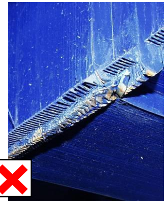
Fig. 13: Não permitido! Pontas deste garfo estão muito dobrados ou tocam-se
