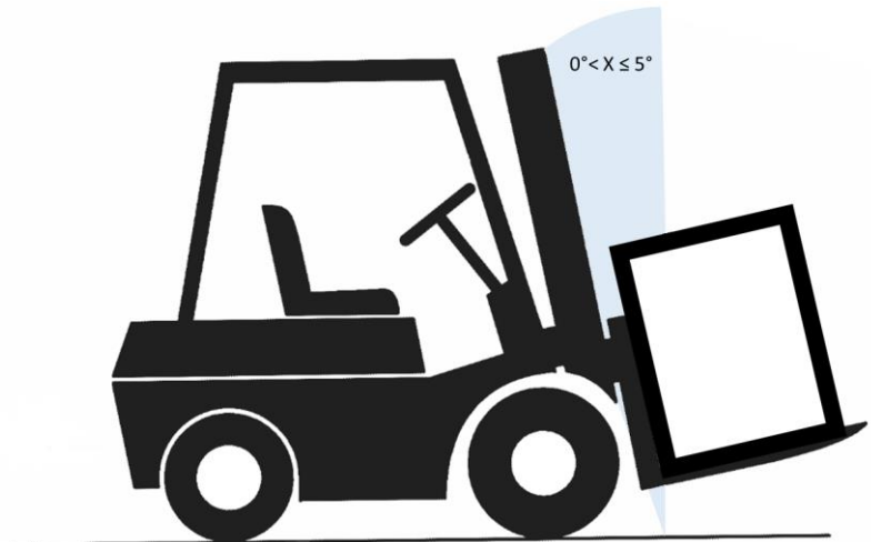
Fig. 9: Ângulo de inclinação para o transporte com empilhador
