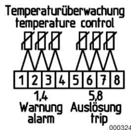
Fig. 3 Exemplo da distribuição de bornes no modelo padrão do controlo da temperatura
